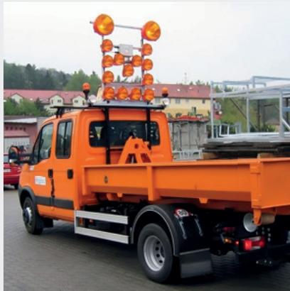
Elektromotorisch klappbarer Halter ermöglicht das Heben oder Senken des Leuchtpfeils durch einen Linearmotor mit Fernbedienung aus der Fahrerkabine.
