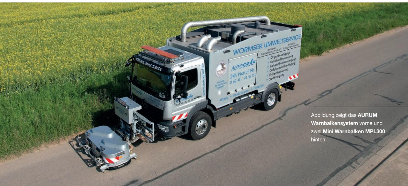
Abbildung zeigt das **AURUM** Warnbalkensystem vorne und zwei **Mini Warnbalken MPL300** hinten.
