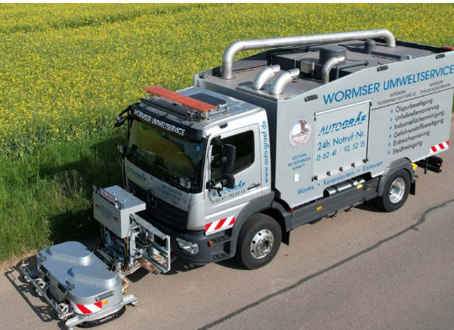
Abbildung zeigt das AURUM Warnbalkensystem vorne und zwei Mini Warnbalken MPL300 hinten.
